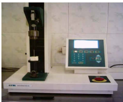
شکل ۳ - اندازه‌گیری سفتی (penetration Test)
