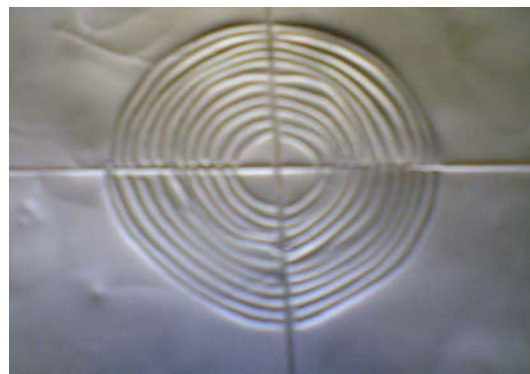
شکل ۱ - روش اندازه‌گیری قابلیت ذوب (Shreiber Test)
