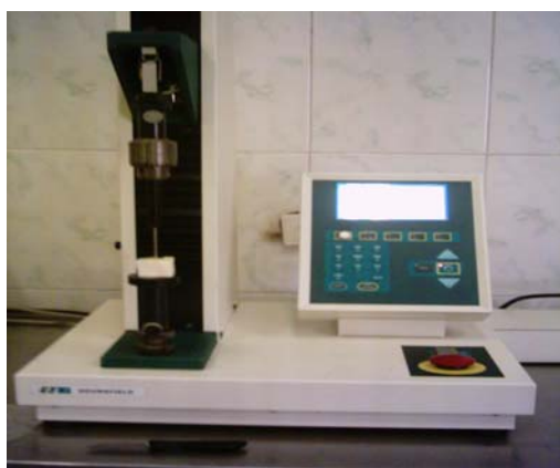
شکل ۳ - اندازه‌گیری سفتی (penetration Test)
