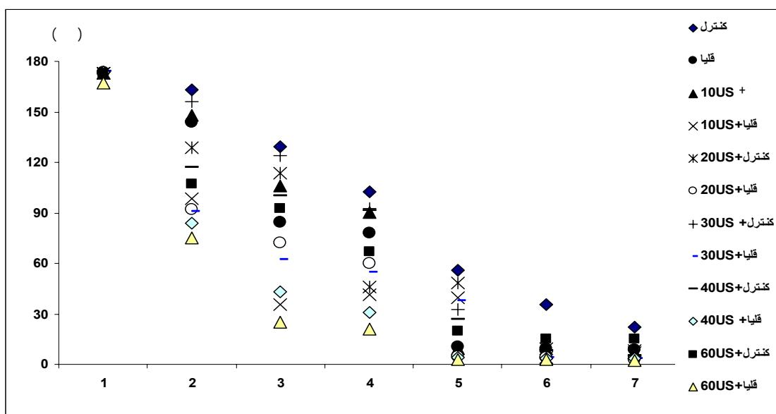
شکل ۹- اثر توامان قلیا و امواج فراصوت بر کاهش وزن انگور طی دوره خشک کردن
