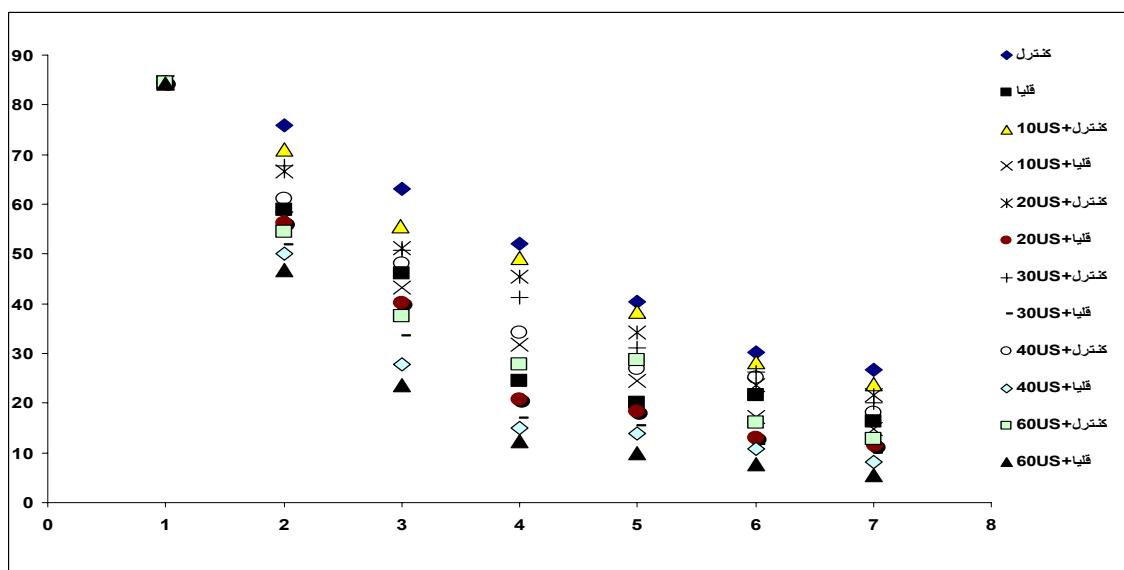
شکل ۸- اثر توام امواج فراصوت و قلیا بر کاهش رطوبت انگور طی دوره خشک کردن
