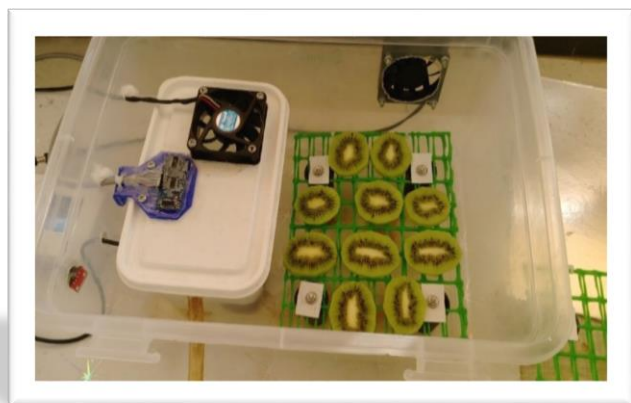
شکل ۱. چینش کیوی‌های برش داده شده در دستگاه مه‌پاش ساخته شده
