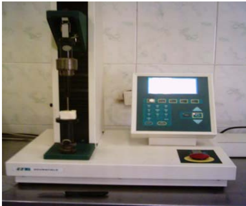
شکل ۳ - اندازه‌گیری سفتی (penetration Test)
