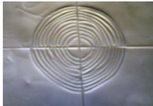
شکل ۱ - روش اندازه‌گیری قابلیت ذوب (Shreiber Test)
