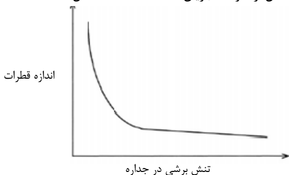
شکل ۲. اثر تنش برشی در جداره بر اندازه قطرات امولسیون‌های روغن در آب تولید شده به روش امولسیون سازی غشایی
