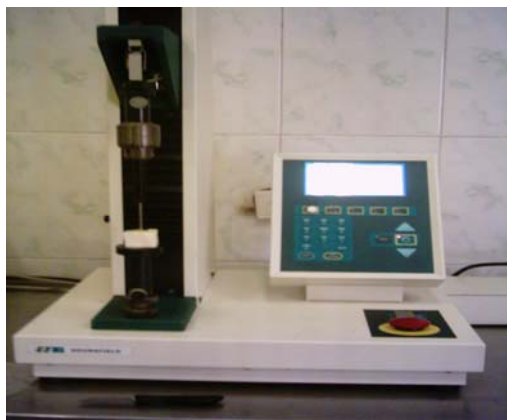
شکل ۳ - اندازه‌گیری سفتی (penetration Test)
