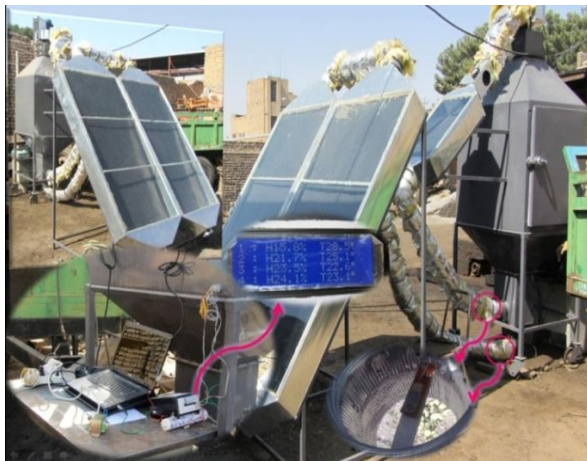
شکل 1. سامانه خشک‌کن خورشیدی فعال غیر مستقیم و اجزای آن
