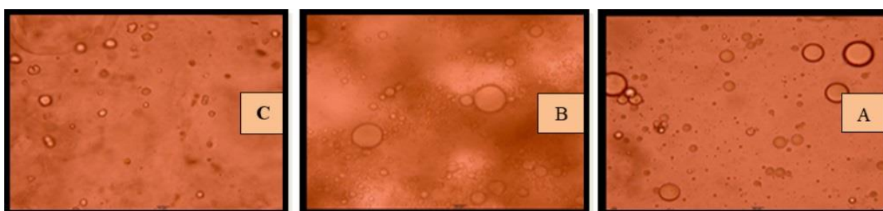
شکل ۳ الف. تصاویر میکروسکوپ نوری میکروکپسول‌های مرطوب با نسبت پروتئین/پلی ساکارید (A) ۱:۱، (B) ۱:۲ و (C) ۲:۱
