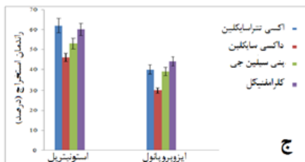
شکل ۱. بهینه‌سازی شرایط استخراج در مرحله HLE: بهینه‌سازی غلظت محلول استات روی (الف)، بهینه‌سازی حجم محلول استات روی (ب)، بهینه‌سازی نوع حلال استخراج/پخش کننده (ج)، بهینه‌سازی حجم حلال استخراج/پخش کننده (د)
