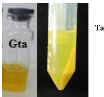
شکل ۲. از راست به چپ: سوسپانسیون نانو کورکومین پس از استحکام دهی با تانیک اسید و گلو تار آلدئید
